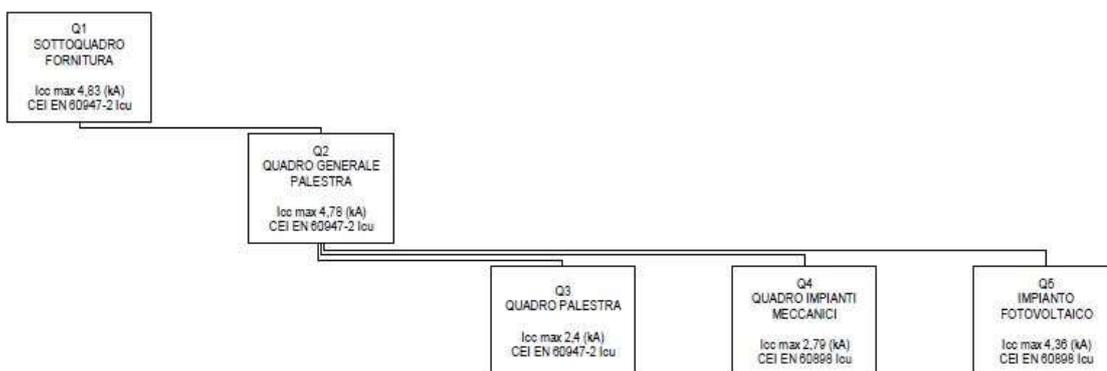
Tutti i circuiti saranno protetti contro i sovraccarichi (tranne i circuiti di sicurezza) e contro i cortocircuiti; tale protezione si otterrà mediante interruttori di tipo magnetotermico.
